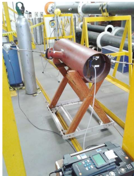
Figura 12 – Aparato experimental utilizado para as medições em montagem tipo dry calibration .
