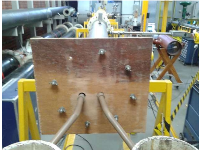
Figura 10 – Tampão flangeado e com furos para injeção de CO 2 .
