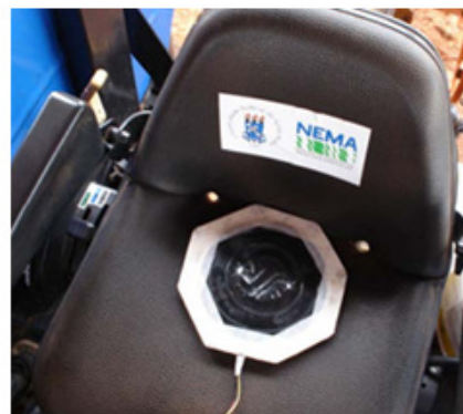
Exemplo de “acelerômetro” e do transdutor instalados em assento para avaliação do nível de vibração.
