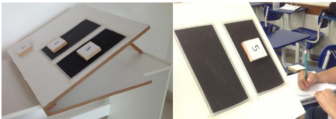
Figura 38 – Experimento descritivo “atrito no plano inclinado”
