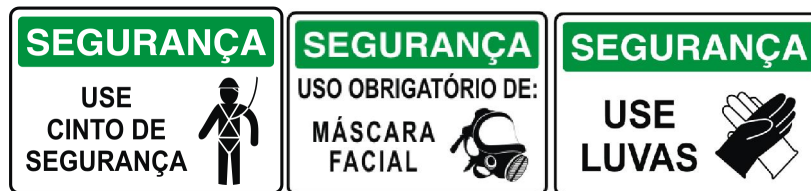
Figura 22 – Extrato do material indicando a utilização de placas de advertência para o uso de Equipamentos de Proteção Individual
