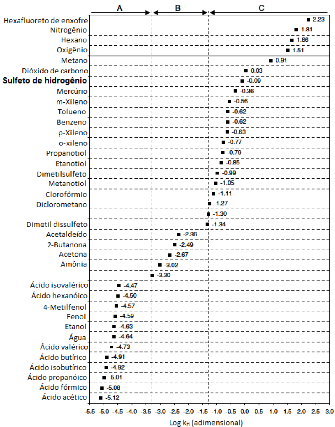
Figura 2 – Valores da constante de Henry adimensional para compostos de importância ambiental e sua relação com o coeficiente global de transferência de massa. As letras indicam que o coeficiente global de transferência de massa é dominado pelas condições de transporte: A – do filme gasoso; B – de ambos os filmes; C – do filme líquido.
