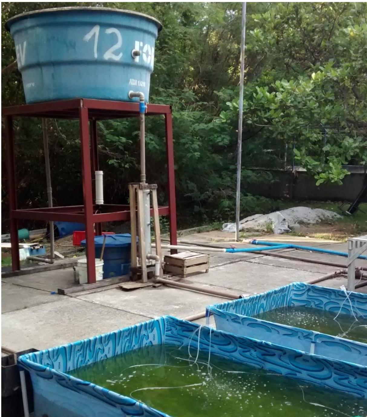
**Figura 18:** Sistema piloto do FBR aberto em batelada para de produção de BMA, localizado nas dependências do Núcleo Água, na Universidade Federal do Espírito Santo - UFES.
