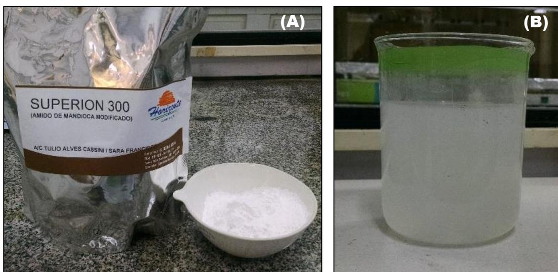
**Figura 10:** (A) Amido de mandioca catiônico SUPERION® 300; (B) solução de amido obtida da mistura do pó com água destilada e solubilizada a 60°C em chapa aquecedora.
