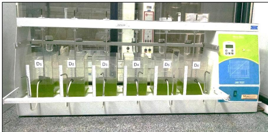
**Figura 14:** Equipamento utilizado para os Testes de Jarros (*Jar-Test*).
