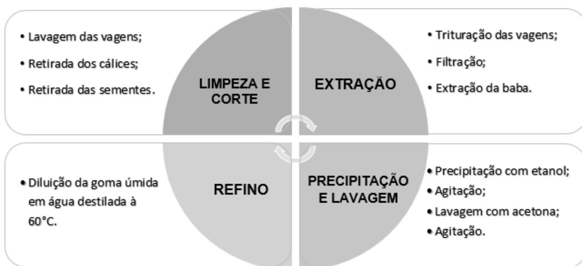
**Figura 11:** Fluxograma representativo das quatro macro-etapas do processo de produção do polímero coagulante à base da goma de quiabo: Limpeza e Corte, Extração, Precipitação e Lavagem e Refino.
