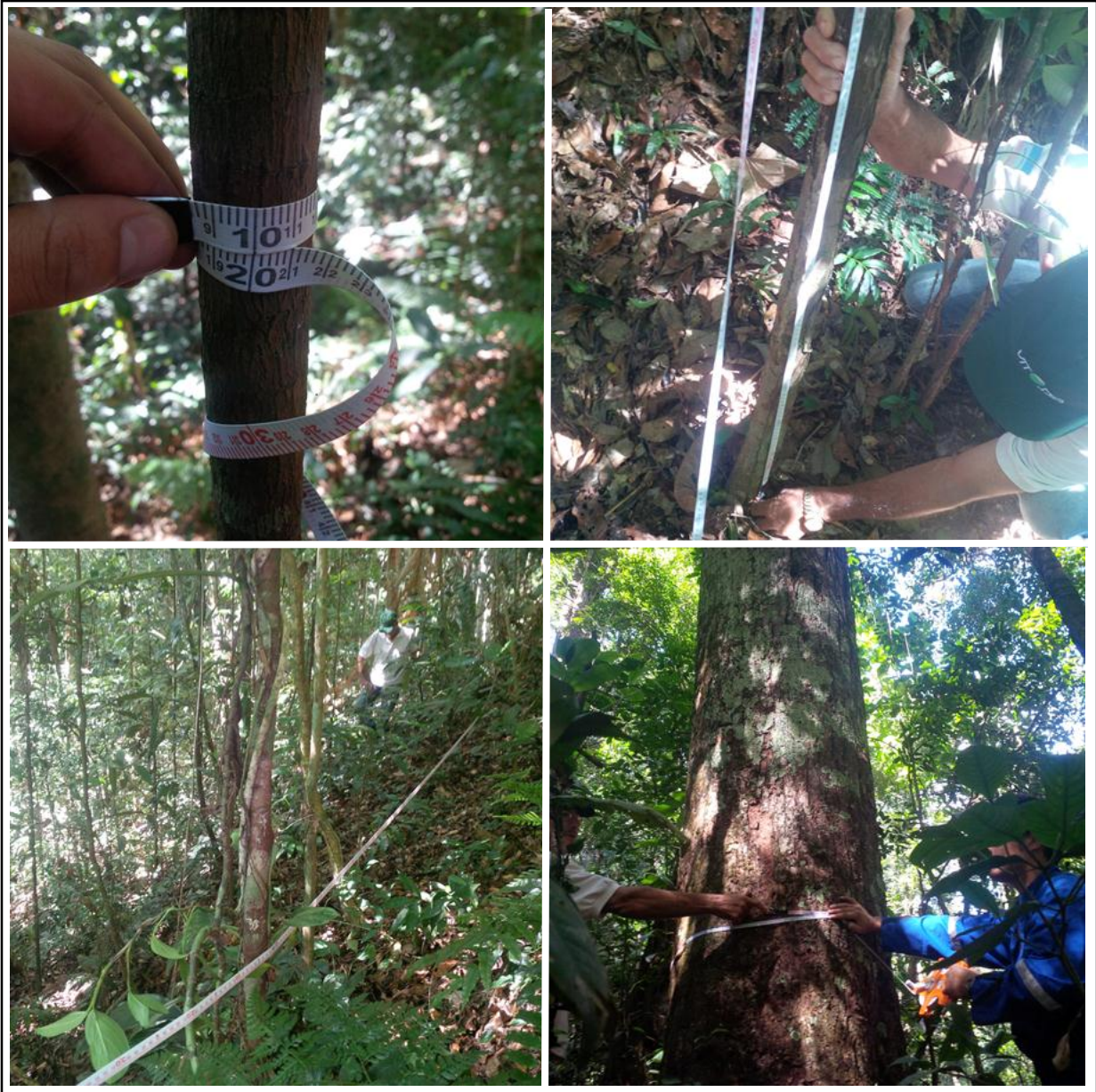
Figura 28 – Registro fotográfico do esquema metodológico para obtenção dos dados de Circunferência a Altura do Peito (CAP) das árvores nas subparcelas amostrais ao redor da estação termopluviométrica que influenciam a quantificação da interceptação pluvial.
