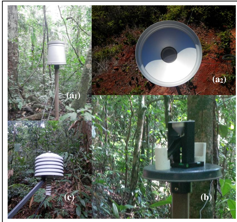
Figura 33 - Registro fotográfico do pluviômetro e seus componentes, funil externo e/ou principal capta o primeiro momento da chuva (a 1,2 ), funil secundário e/ou interno receptor do funil principal e bscula dupla com marcador de camba (b). Sensor de umidade e temperatura (c). Elementos utilizados nas estaes termopluviomtricas de precipitao total e precipitao internana RBDB.
