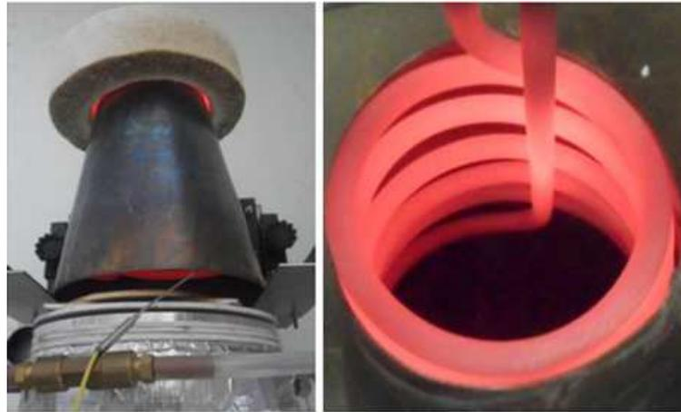
Figura 14– Aquecedor cônico utilizado neste trabalho.
