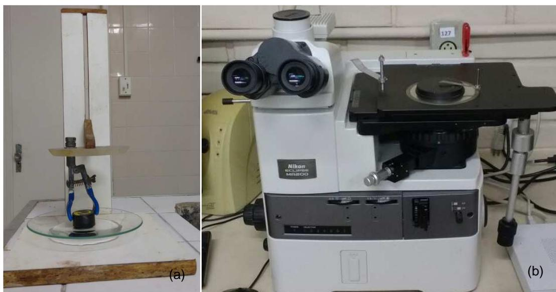
Figura 24– (a) Esquemático para ataque por imersão das amostras; (b) Microscópio óptico.
