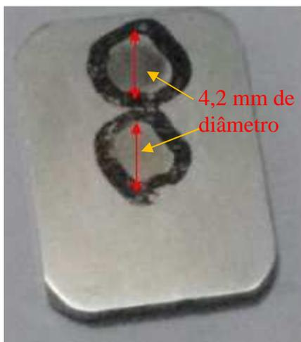
Figura 23– Amostra utilizada no ensaio DL-EPR, mostrando as regiões ensaiadas e suas dimensões.
