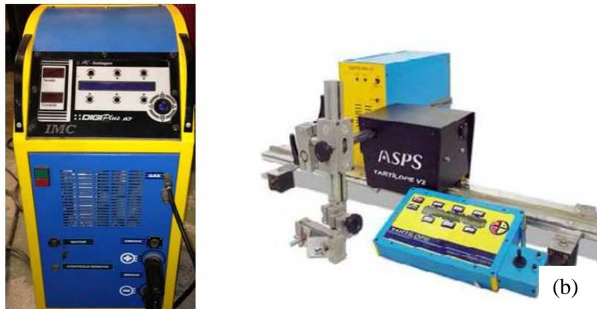
Figura 18– (a) Fonte de soldagem DigiPlus A7– IMC Soldagem; (b) Tartilope V2
