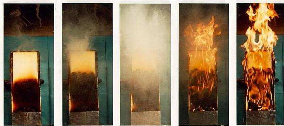
Figura 4 – Experimento ilustrando a transição *smouldering* para *flaming* em um material de poliuretano.
