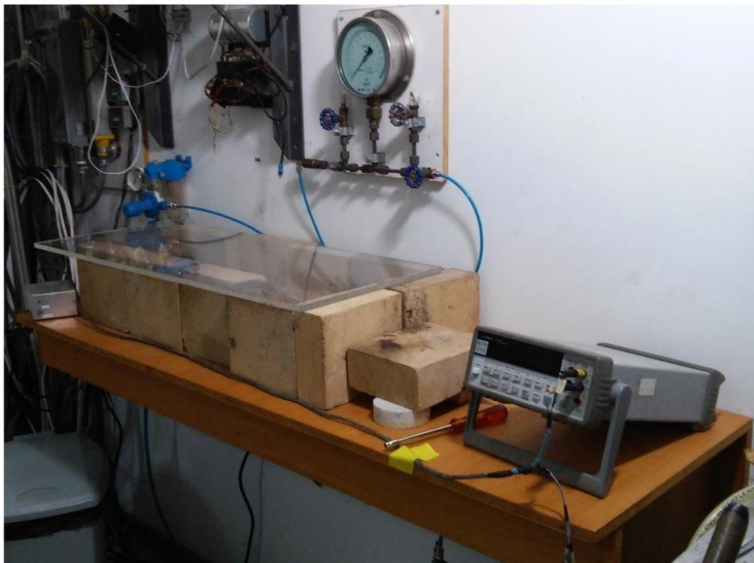
Figura 6.10 - Bancada de calibração do Analisador Termobarométrico. A placa de acrílico e os tijolos são utilizados para a segurança do operador. O voltímetro de alta resolução (Direita) é o mesmo utilizado nos experimentos.
