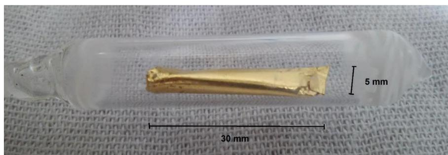
Figura 7.1 - Envelope porta-amostra feito de ouro.
