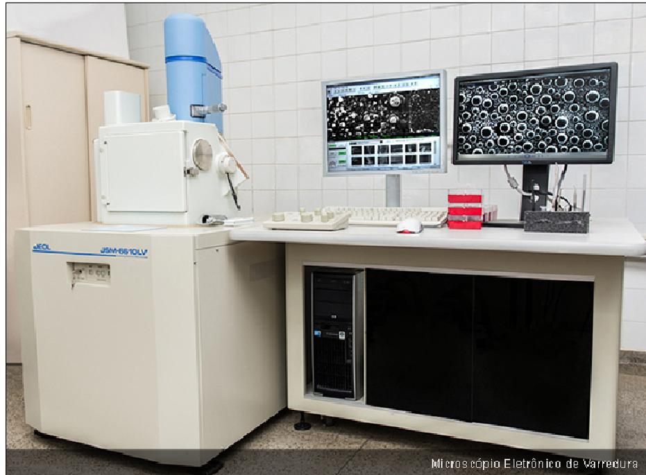
Figura 22: Microscópio eletrônico de Varredura JEOL JEM-1400, do Laboratório de Ultraestrutura Celular Carlos Alberto Redins (LUCCAR) – Universidade Federal do Espírito Santo.
