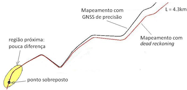
Figura 57 – Distorção geométrica (erro acumulativo) em nosso esquema de mapeamento baseado em dead reckoning
