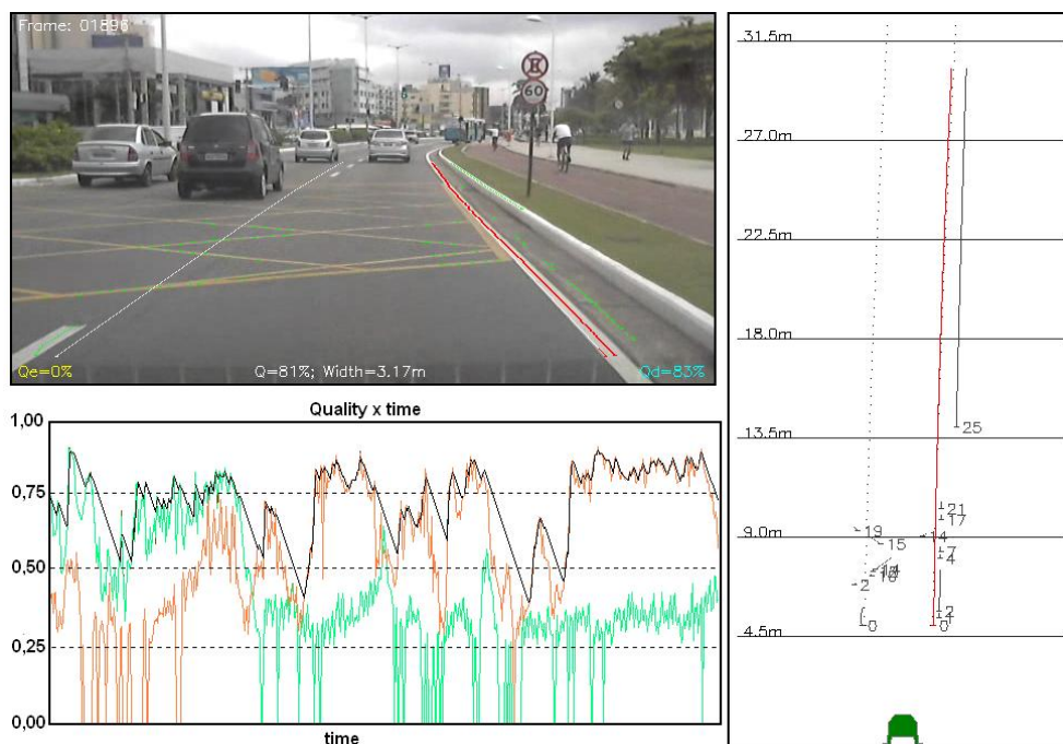
Figura 42 – Um quadro do vídeo demonstrativo do algoritmo de detecção visual operando: acima - imagem da câmera; abaixo Gráfico da qualidade do modelo; a direita projeção perspectiva inversa. Acessível em < http://youtu.be/mwSNEWhbJhg >
