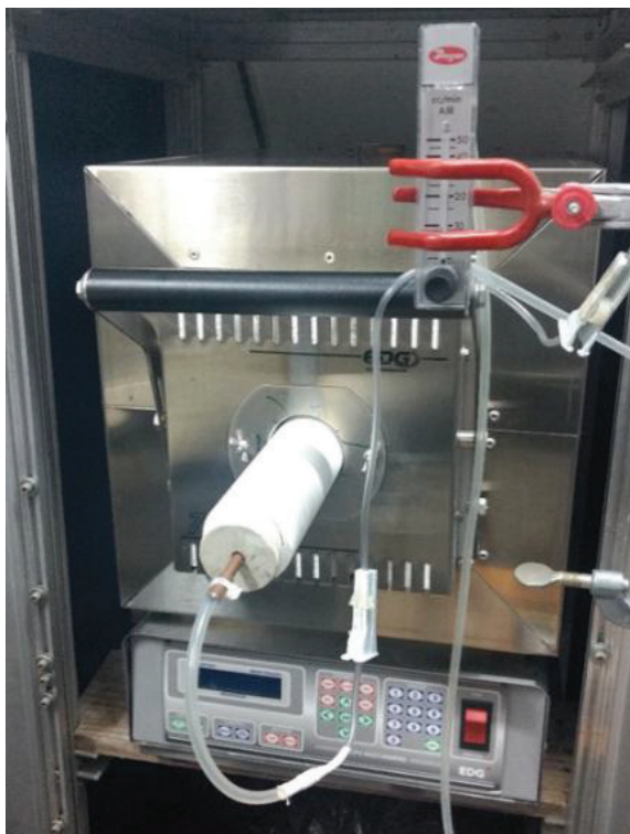
Figura 10 - forno mufla com tubo de alumínio transpassado e com microprocessador, Marca: EDG Modelo F-7000 10P, com Tensão de trabalho 220V.
