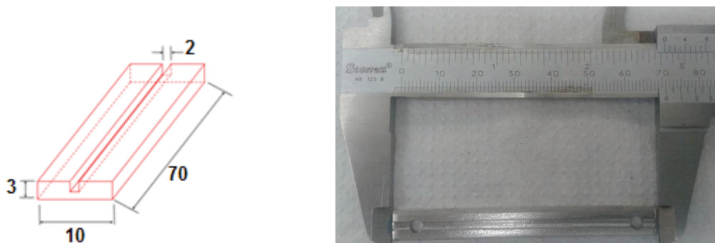
Figura 09 - Substrato após processo de fabricação (dimensões em escala de milímetro).
