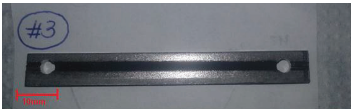
Figura 11 - Amostra de aço inoxidável AISI 304L com deposição da cerâmica \text{YBa}_2\text{Cu}_3\text{O}_{7-\delta} .
