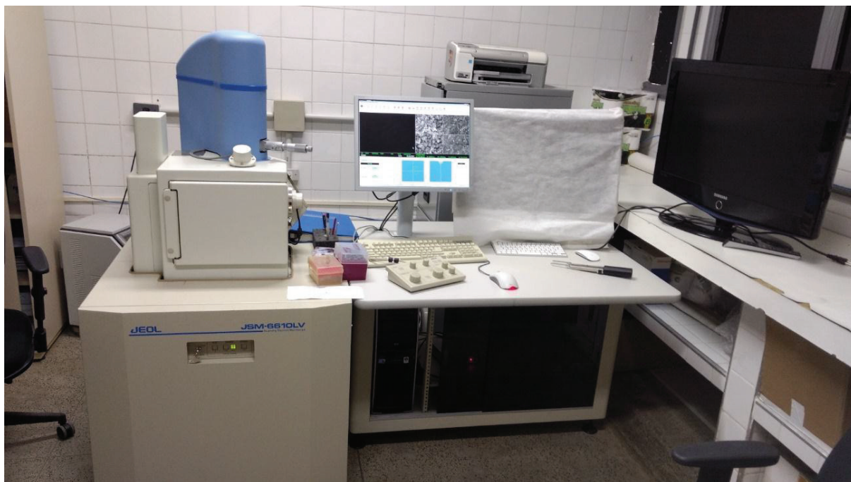
Figura 12 - Microscópio eletrônico JEOL Modelo JSM 6610 LV, do Laboratório de Ultraestrutura Celular Carlos Alberto Redins- LUUCAR, Centro de Ciências da Saúde - UFES.
