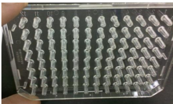
Figura 9 - Sistema para produção de biofilme constituído por pegs em tampa de poliestireno modificadas ( peg-lid ) para microplaca de 96 poços, que constitui o “dispositivo Calgary”.
