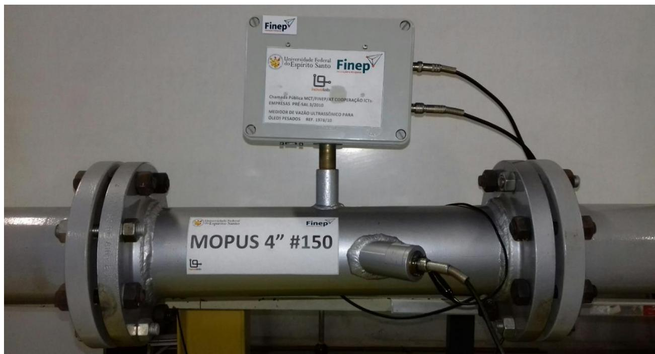
Figura 16: Medidor ultrassônico MOPUS  $\varnothing$ 4" #150, instalado no circuito de testes.
