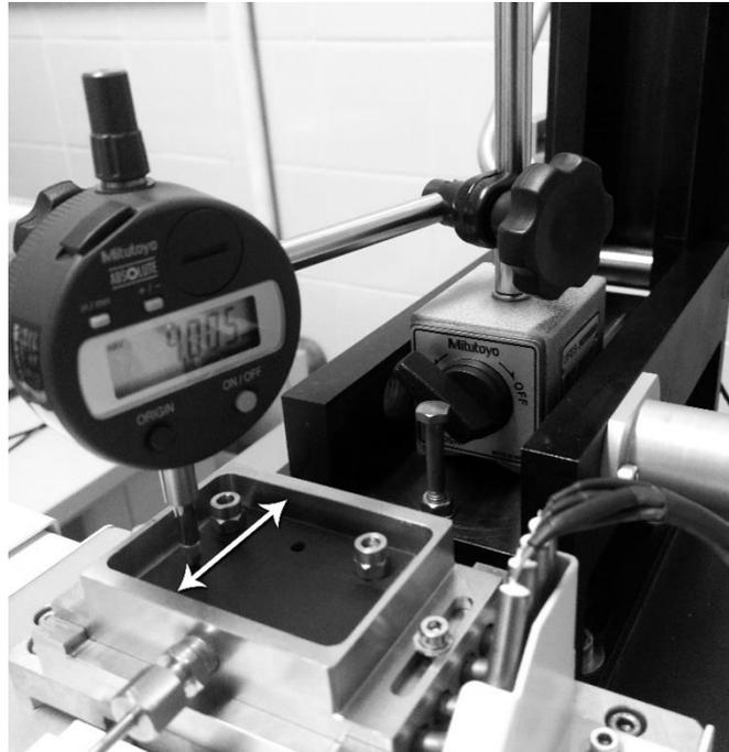
Figura 41 – Sistema montado para encontrar o centro de curvatura da amostra de PA6 para posterior alinhamento com o pino. Fonte: Autor.
