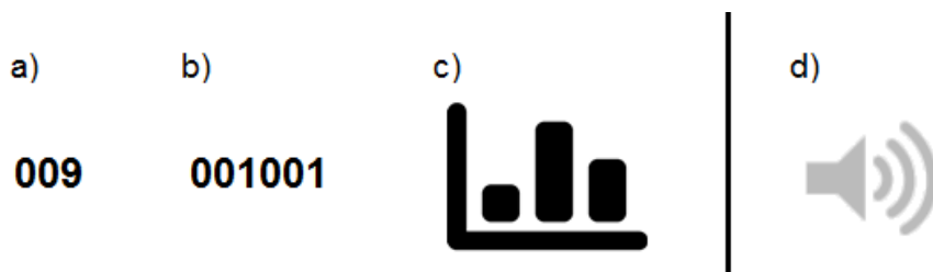
Figura 14. Estágios de uma mensagem a ser transmitida pelo Emitter : a) Mensagem em decimal; b) Mensagem codificada para binário; c) Mensagem convertida para um sinal acústico; d) Transmissão do sinal acústico. Fonte: Produção do próprio autor.
