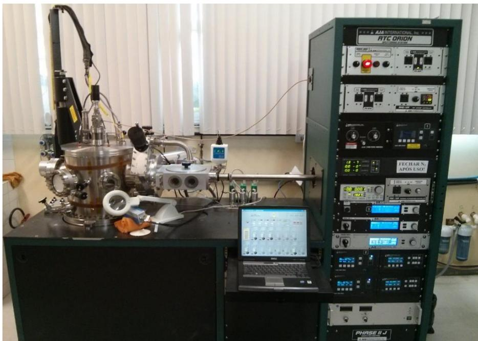
Figura 3.2 - Foto do equipamento *Magnetron Sputtering* instalado no LEMAG.
