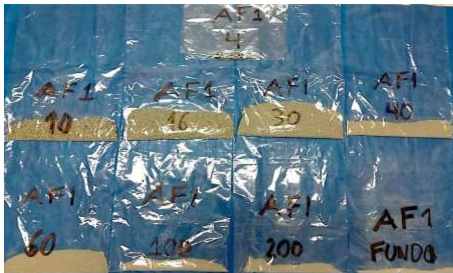
Figura 3.3. Amostras do alto-forno 2 separadas de acordo com as frações granulométricas. Fonte: Autor
