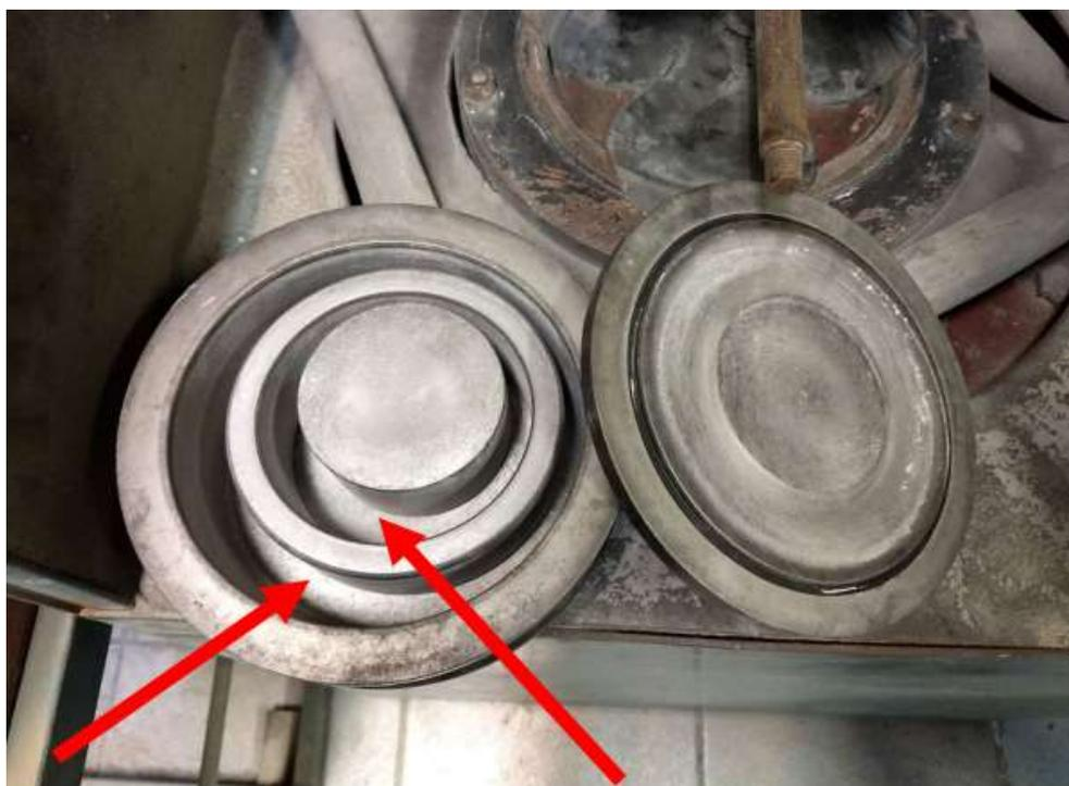
O moinho de argolas, ao ser ligado, basta apenas quarenta segundos para que ocorra a moagem das amostras e que assim possa ser coletado o material moído. Com o objetivo de garantir uma uniformidade do particulado, todas as amostras deste trabalho foram passadas por uma peneira de 75 micrometros após o processo do moinho de argolas, garantindo assim, que todas as amostras possuam partículas com tamanho menor que 75 micrometros.
