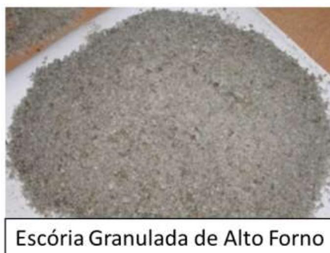
Devida a semelhança da escória granulada de alto-forno com a areia de fundição, a mesma se mostra eficiente na substituição parcial ou total da areia na composição do concreto. É possível que, neste concreto obter-se-á uma redução da quantidade de cimento e água utilizados na mistura e apresenta uma melhoria na resistência à tração. Vale destacar a possível redução de custo desse concreto visto o menor consumo de água e cimento [41].
