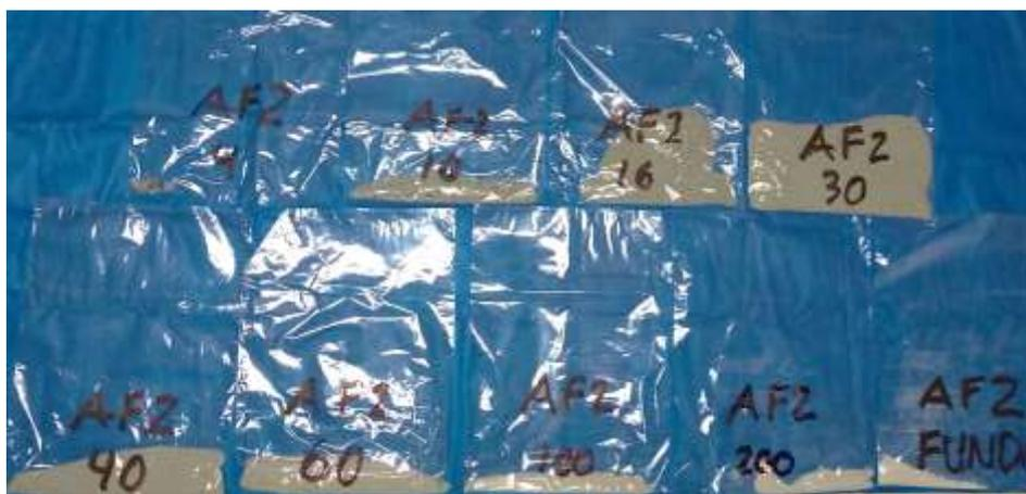
Figura 3.4. Amostras do alto-forno 3 separadas de acordo com as frações granulométricas. Fonte: Autor
