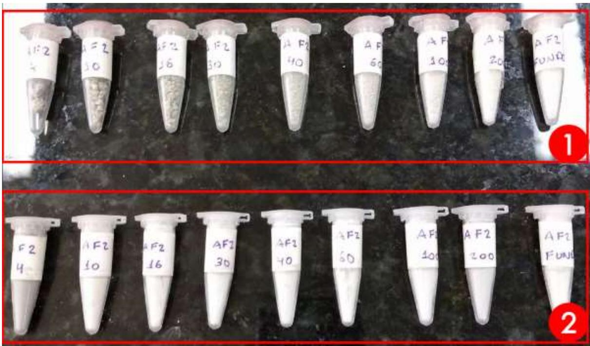
Figura 3.8. Comparação das amostras do alto-forno 3 que foram separadas de acordo com as frações granulométricas mostrando o antes e depois do moinho de argolas. Fonte: Autor
