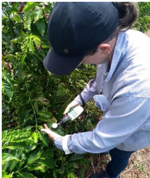
Figura 2: Determinação dos índices de pigmentos (ICTD, IFLA, IANT) e IBN através do clorofilômetro portátil Dualox (Force-A, Orsay, França), em genótipos de C. canephora .
