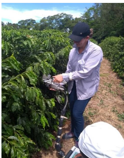
Figura 6: Determinação de par\u00e2metros de fluoresc\u00eancia da clorofila a com a utiliza\u00e7\u00e3o do analisador de gases a infravermelho (IRGA, Li 6400XT, Li-Cor, Lincoln, EUA, 1996).
