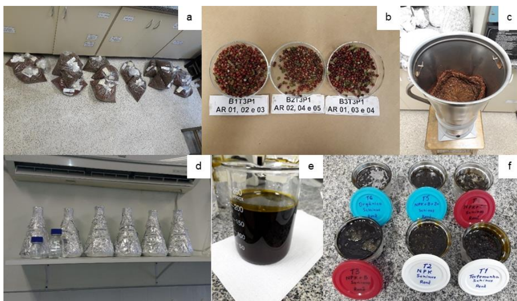
Figura 16 – Etapas de produção dos extratos etanólicos, onde: (a e b) seleção do material vegetal e produção do “pool” por tratamento; (c) trituração e homogeneização do material; (d) exposição ao solvente (ciclos de maceração); (e) extrato após ciclos de rotaevaporação; e (f) extratos vegetais prontos e identificados. Fonte: Acervo do autor (2018).
