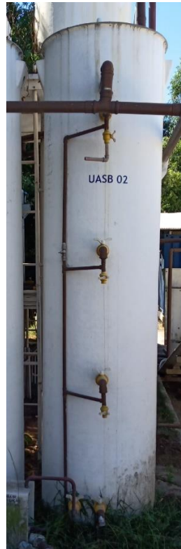
Figura 4.2 – Reator UASB em escala piloto.
