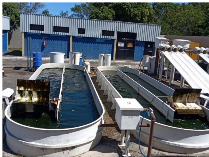
Figura 4.3– Lagoas de alta taxa em escala piloto.
