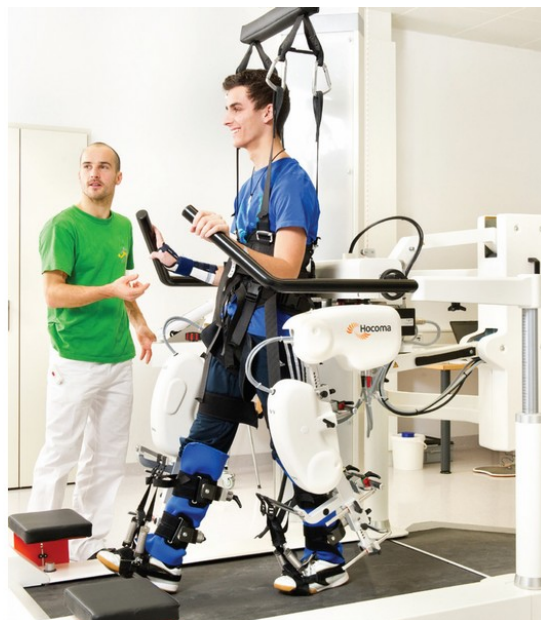
Figura 2 – Dispositivo de Reabilitação Lokomat®(Hocoma, Suíça)
