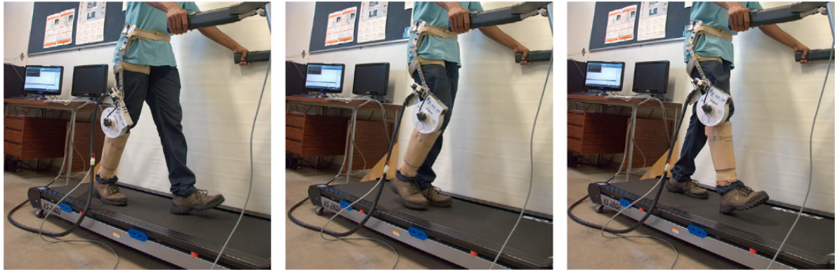
Figura 4 – Atuador elástico em serie fixado na órteses de joelho, (USP-São Carlos, Brasil) [3].
