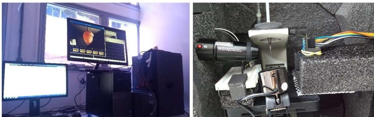
**Figura 4.** Imagem externa do segundo protótipo durante a realização dos testes com LEDs de diferentes comprimentos de onda e câmeras para visualização do processo (à esquerda). Imagem interna da configuração do segundo protótipo para monitorização por vídeo (à direita).
