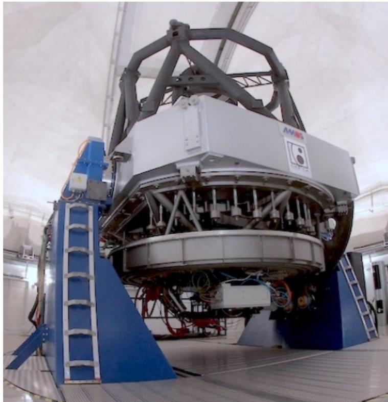
**Figura 4.1.** Imagem do telescópio JST/T250 utilizado para a pesquisa miniJPAS, com o JPAS-Câmera Pathfinder.
