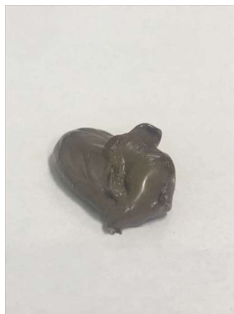
Figura 14. Protótipo da madeira plástica (Grupo A). Dados da pesquisa.
