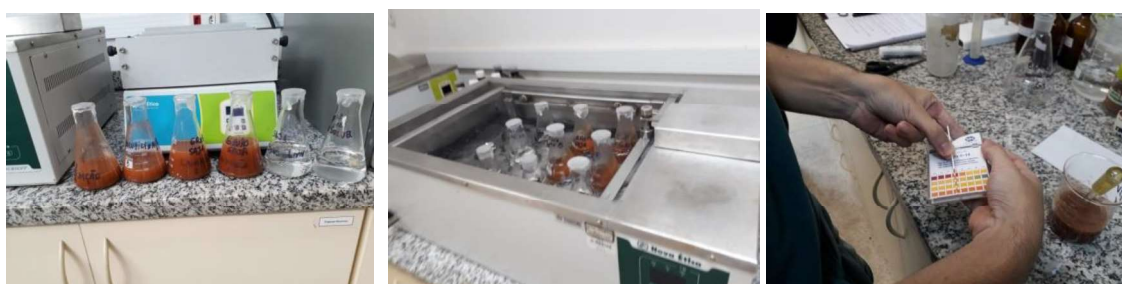
Figura 8. Lixiviação e solubilização (à esquerda); banho-maria (centro) e medição de pH para determinar solução extratora (à direita). Arquivo pessoal.
