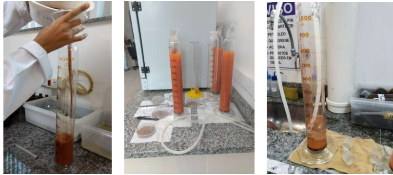
Figura 11. Etapa experimental III – Separação de silte e argila. Arquivo pessoal.
