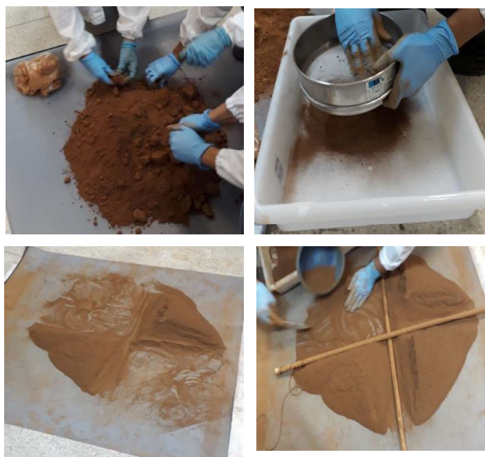
Figura 7. Destorroamento (em cima, esquerda); peneiramento (em cima, direita); quarteamento (inferior). Arquivo pessoal.
