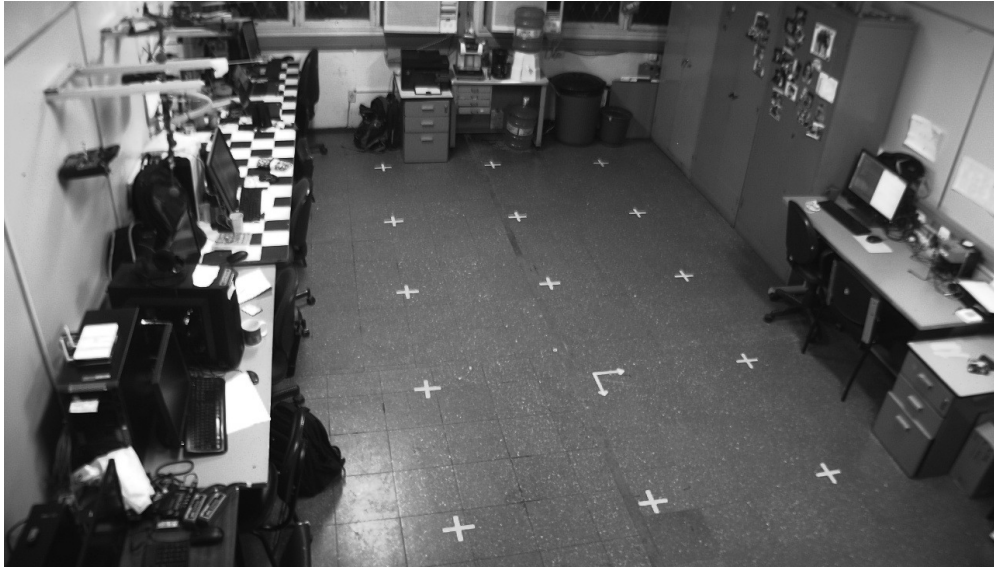
Figura 35 – Imagem capturada por uma das câmeras do PIS com os pontos marcados no chão
