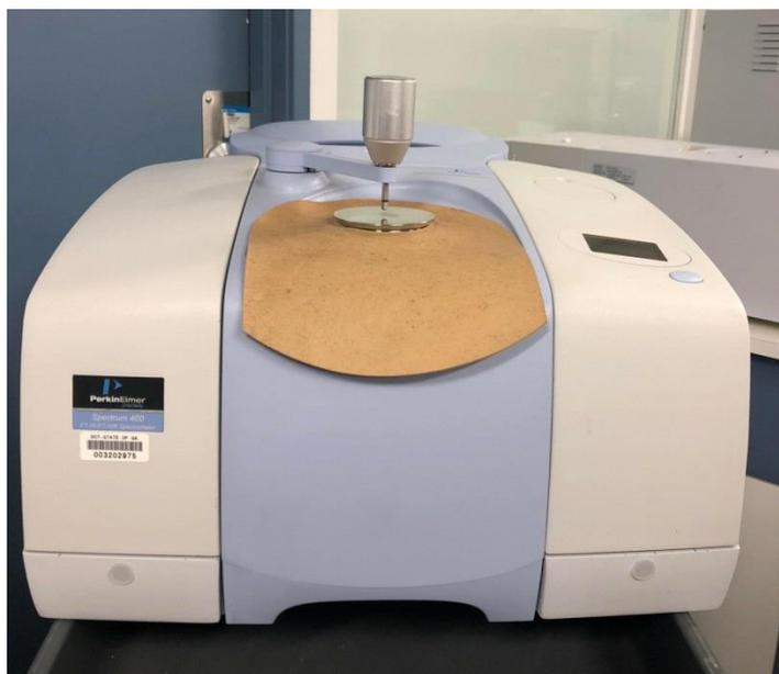
Figura 8. Espectrômetro de IV PerkinElmer® Spectrum 400 FTIR.
