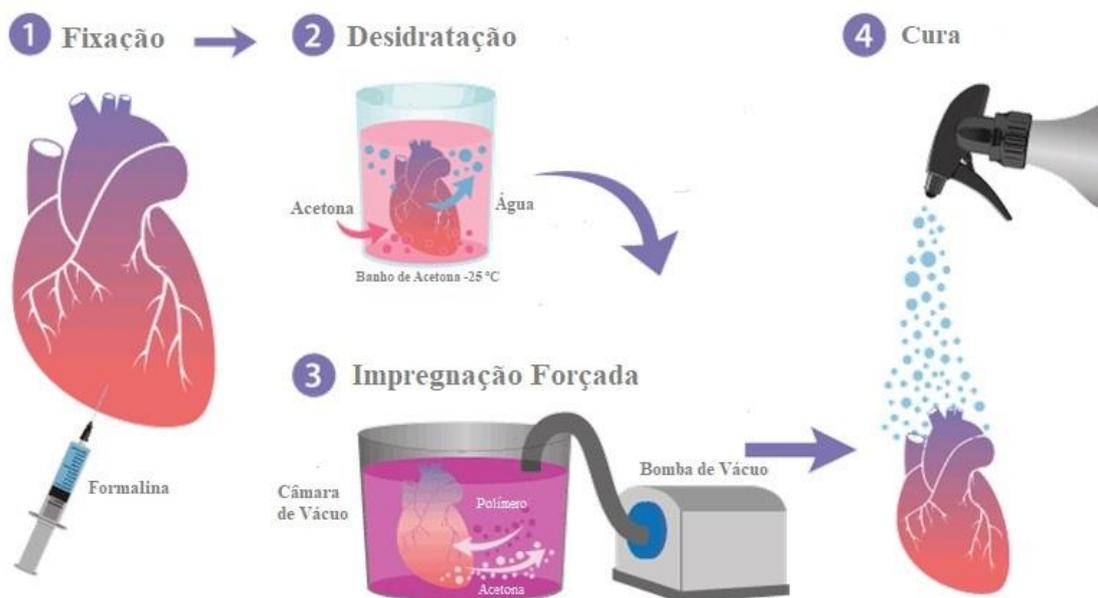
Figura 1. Esquema das etapas fundamentais da técnica de plastinação.
