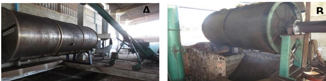
Figura 31. Secadores dos produtores das amostras de pimenta-do-reino coletadas (A): Secagem mecânica com fogo indireto (MFI); (B): Secagem mecânica com fogo direto (MFD). Fonte: Acervo Pessoal.
