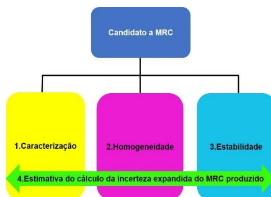
Figura 4. Esquema representativo da estimativa de incerteza de um candidato para material de referência certificado.
