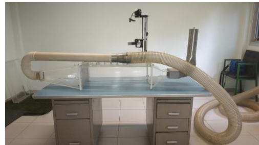
Figura 7 - (a) Esquema montado para funcionamento do túnel de vento portátil. (b) Foto do túnel de vento portátil utilizado nos experimentos. (c) Vista superior do túnel de vento com a localização dos pontos de amostragem.
