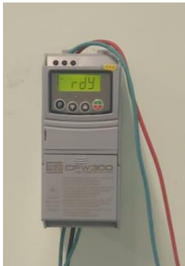
(a) Inversor de frequências
