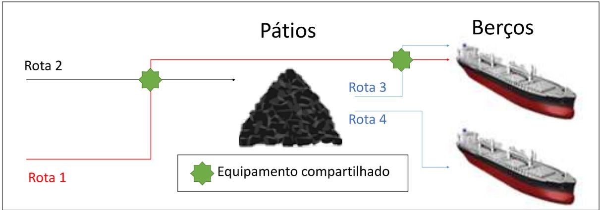
Figura 5 – Equipamentos compartilhados pelas rotas 1 e 2 (correia transportadora) e 1 e 3 (carregador de navio).
