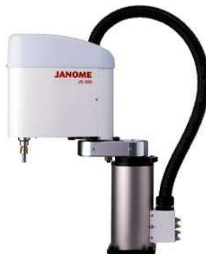
Figura 1.1: Um robô manipulador tipo SCARA. Figura obtida em http://www.scara-robots.com/scara.htm .
