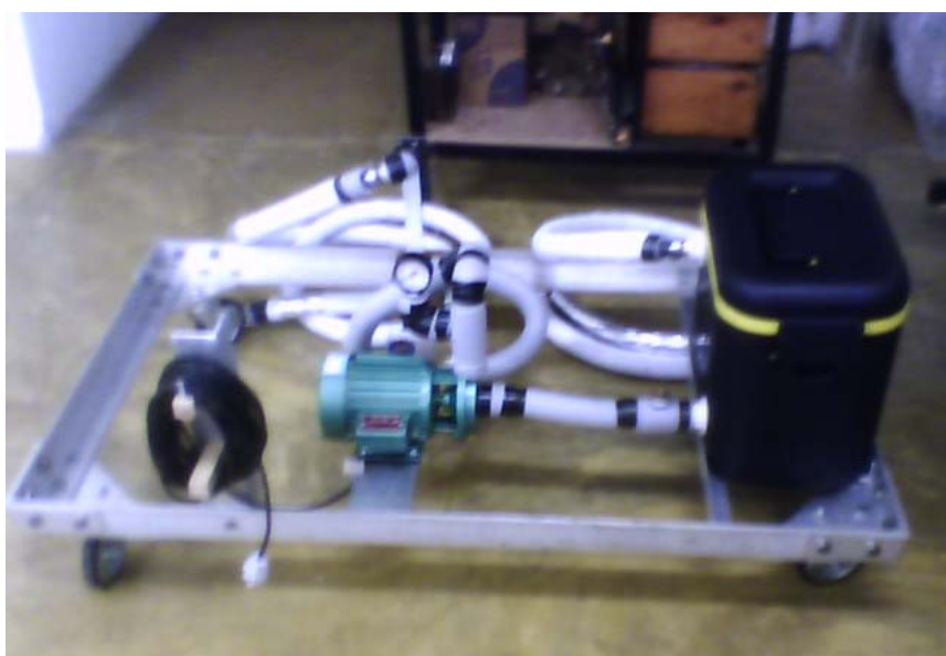
Figura 24 – Base móvel do circuito fechado
