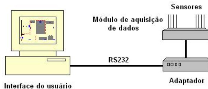
Figura 4-3 – Conexão dos sensores por ligação a cabo.
