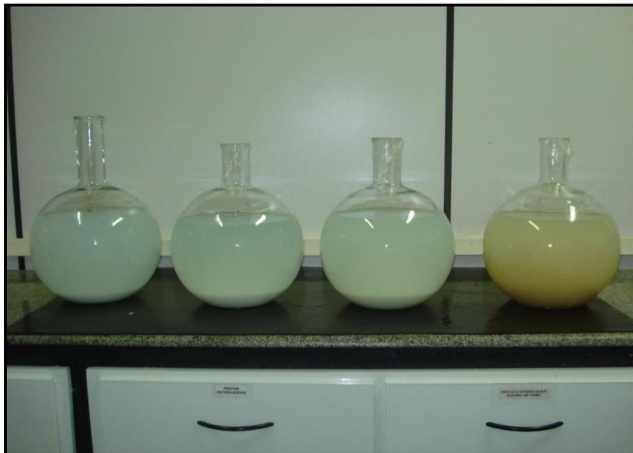
Figura 10. Amostras de água bruta, filtrada e tratada em repouso para decantação dos protozoários.
