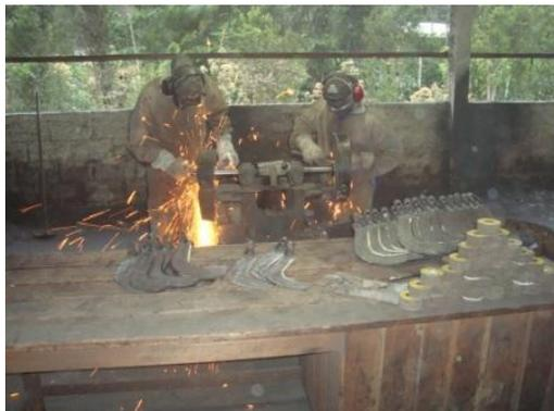
Máquina utilizada para afiar as lâminas das peças em geral e acabamentos finais dos cabos de facas. Ao todo são onze esmeris e trabalham um ou dois acertadores por máquina.
