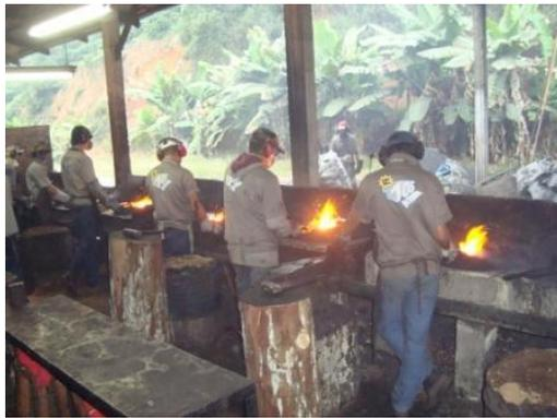
As peças são aquecidas em fornos e em seguida são imersas em banho de óleo frio, potencializando a durabilidade e resistência à superfície de corte da peça. Na têmpera, o trabalhador fica com a peça diretamente sobre fogo (têmpera aberta), em seguida, golpeia com uma marreta sobre a peça em cima de uma bigorna.
