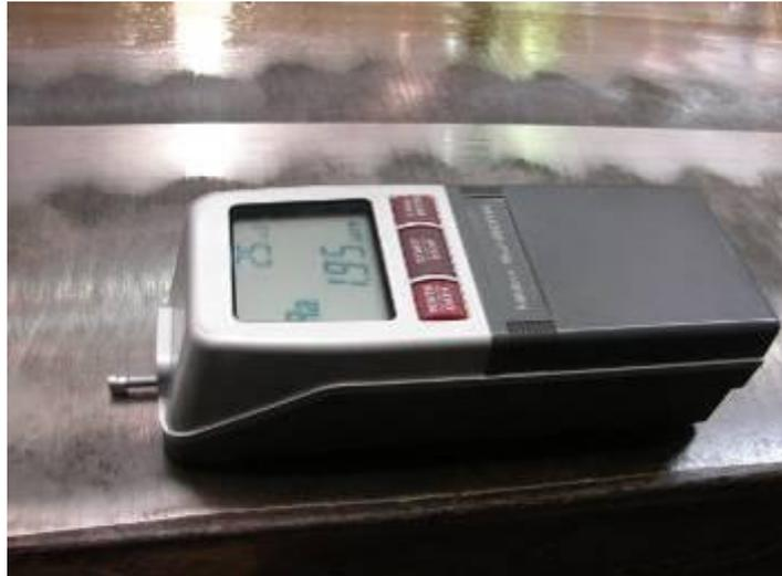
Figura 52 - Fotografia do rugosímetro utilizado.
