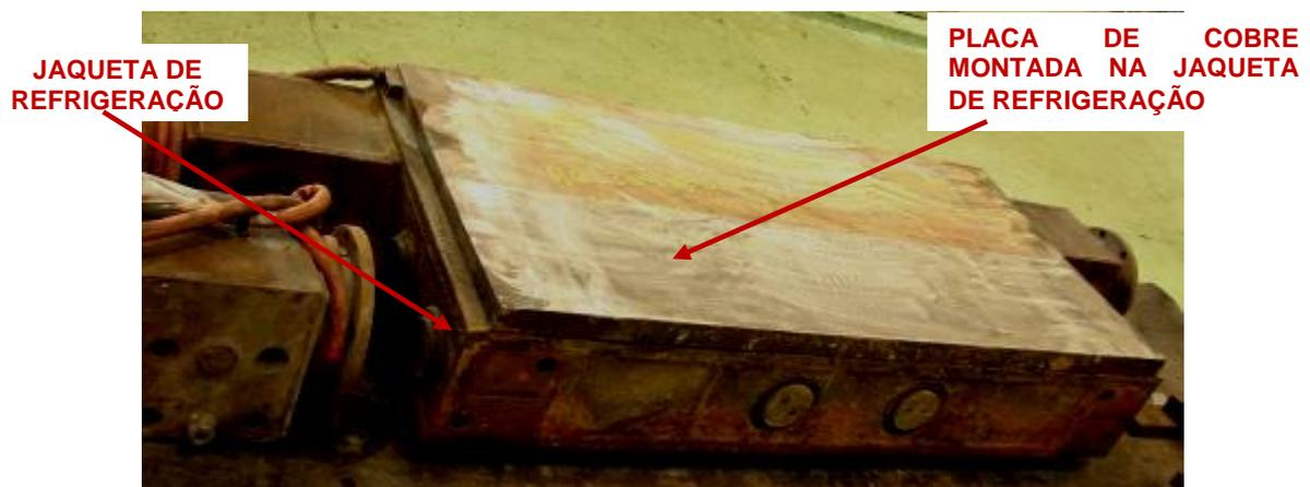
Figura 34 - Fotografia do conjunto placa de cobre (MLC1) montada na jaqueta de refrigeração.
