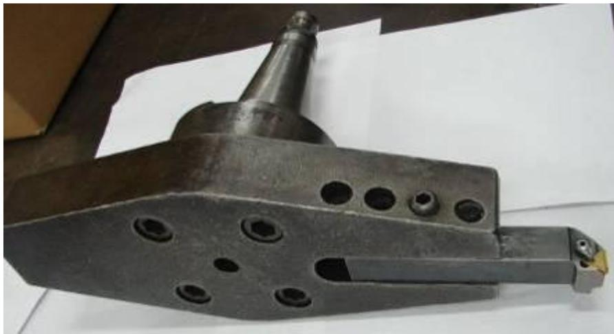
Figura 45 - Fotografia do conjunto cone ISO, barra de mandrilar, suporte de ferramenta e inserto de metal duro utilizado na usinagem da superfície de níquel.
