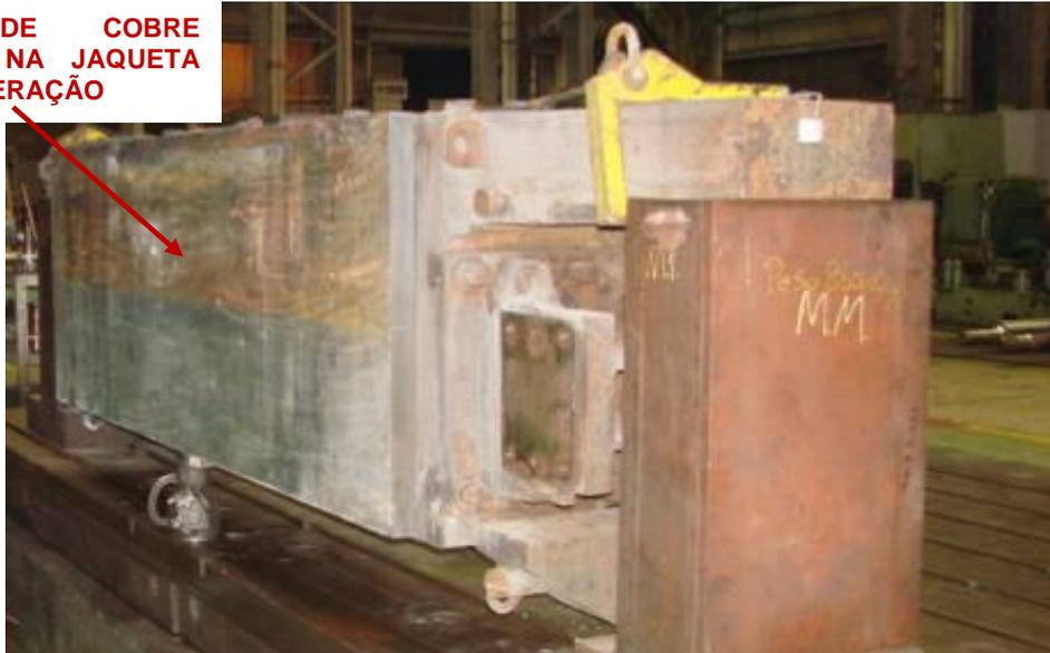
Figura 35 - Fotografia do conjunto placa de cobre (MLC2) montada na jaqueta de refrigeração, travada e posicionada para usinagem.
