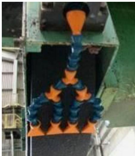
Figura 49 - Fotografia dos bocais de aplicação de fluido de corte.
