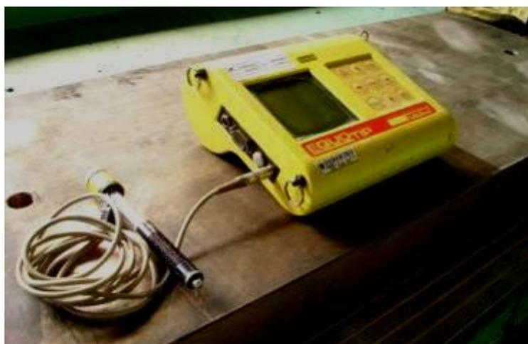
Figura 51 - Fotografia do durômetro utilizado.
