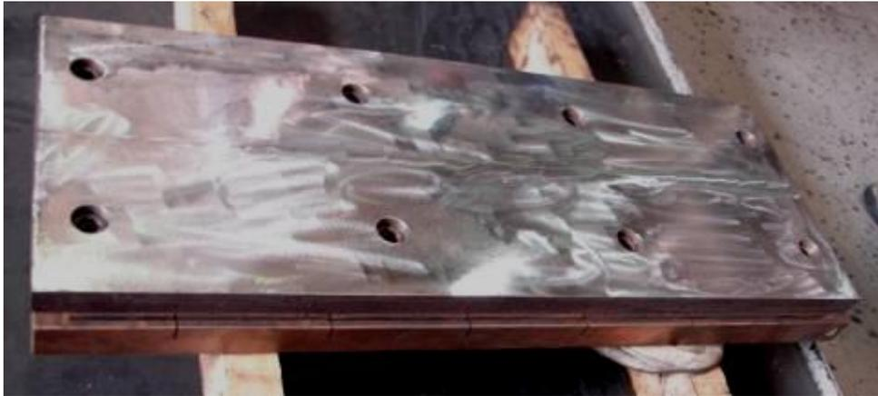
Figura 37 - Fotografia do suporte de aço e amostra da placa de cobre montados.
