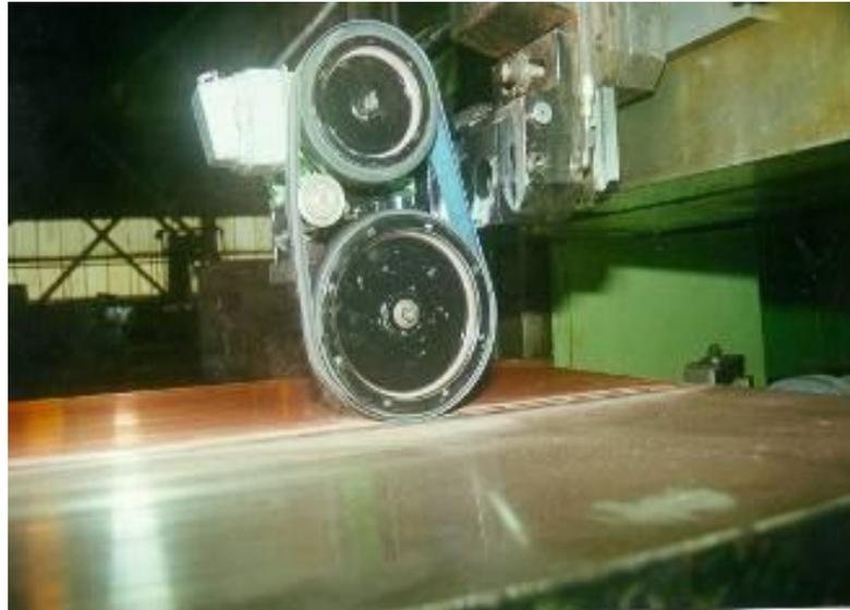
Figura 43 - Fotografia do cabeçote lixador utilizado no acabamento das placas da MLC 1.
