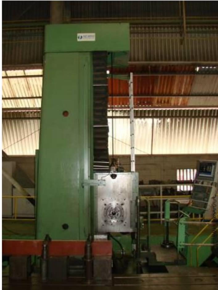
Figura 44 - Fotografia da mandriladora/fresadora utilizada.
