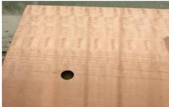
Figura 58 - Fotografia da amostra com presença de sulcos sem aumento ( $a_e = 0,02$  mm e  $V_f = 20$  m/min).
