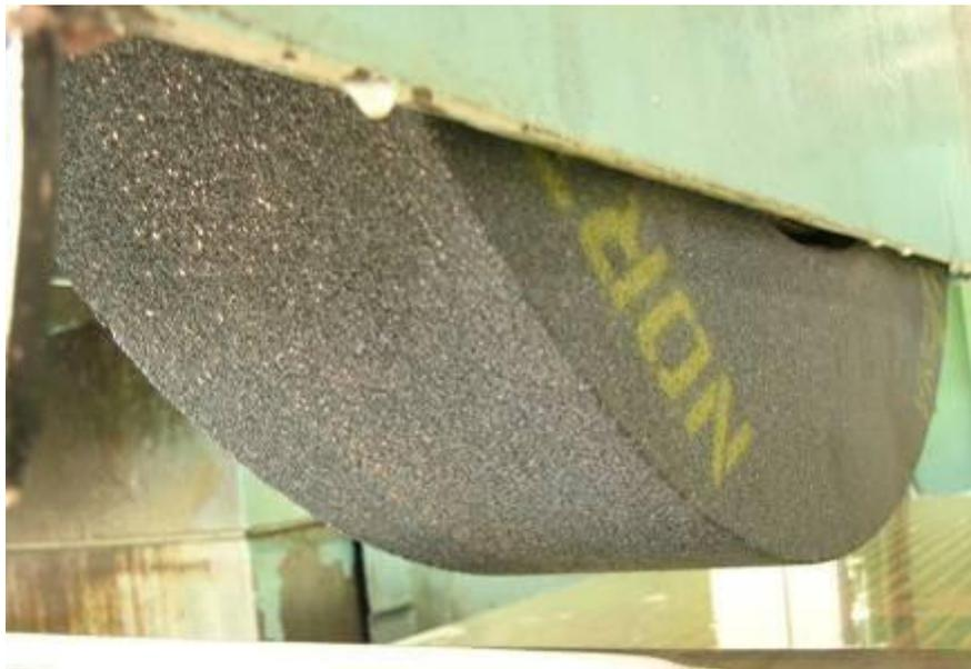
Figura 63 - Fotografia do rebolo com evidências de empastamento ( $a_e = 0,02$  mm).
