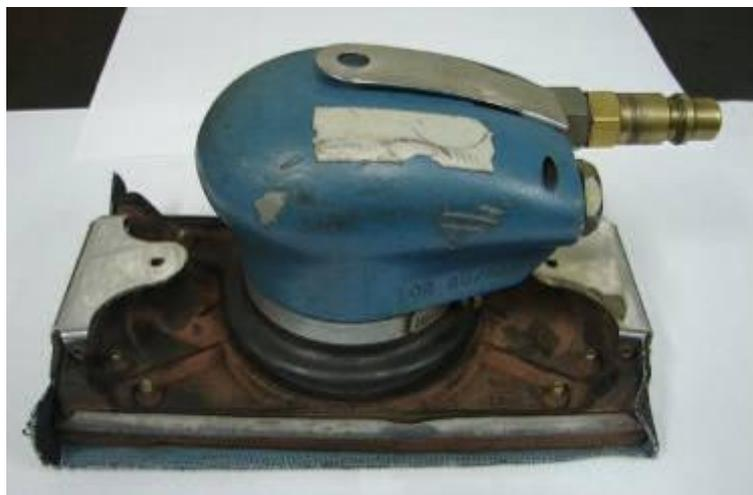
Figura 47 - Fotografia da lixadeira orbital utilizada no acabamento manual da placa do molde da máquina de lingotamento 2.
