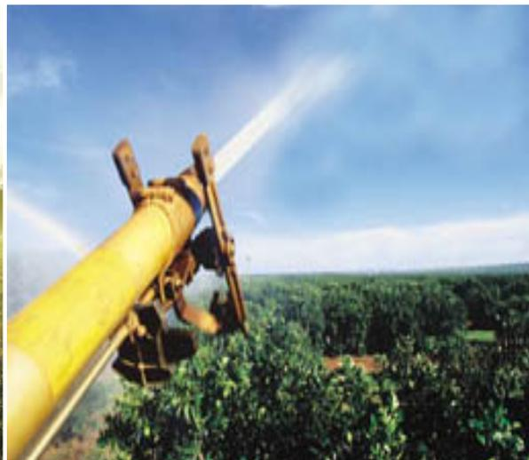
**Figura 6** Sistema de aspersão por canhão hidráulico.
