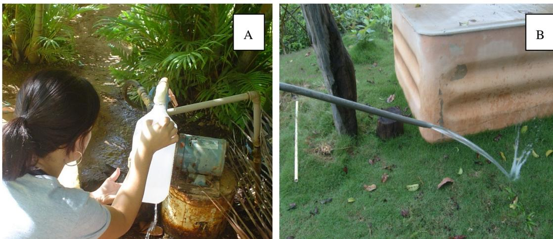
**Figura 11** Amostragem de água subterrânea: saída da bomba (A) e da torneira (B).
