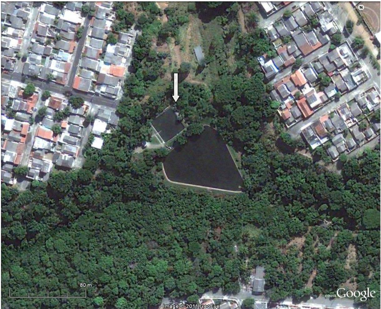
Figura 4-1- Foto da Estação de Tratamento de Esgotos de Porto Canoas, lagoas anaeróbia e facultativa. Fonte: Google (2011)
