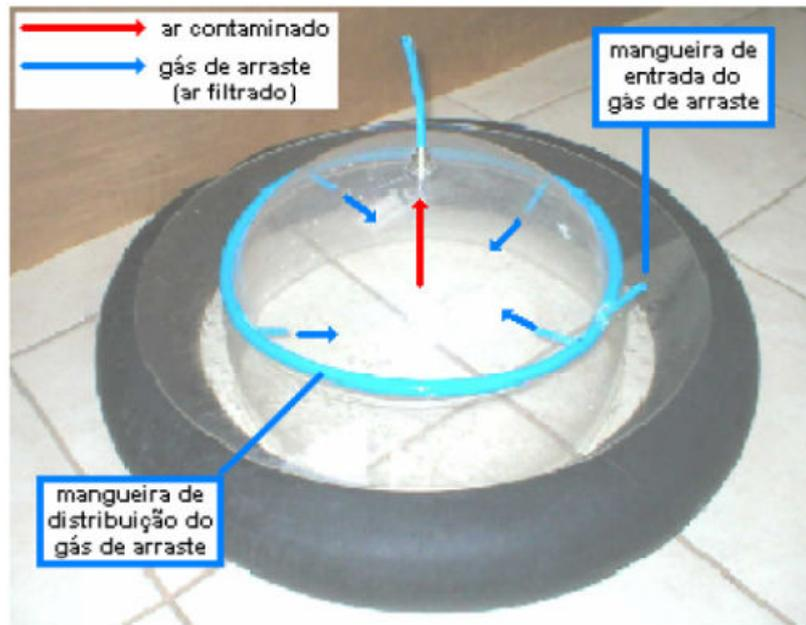
Figura 3-7 - Câmara de fluxo dinâmica. Fonte: SCHIMMER(2004).
