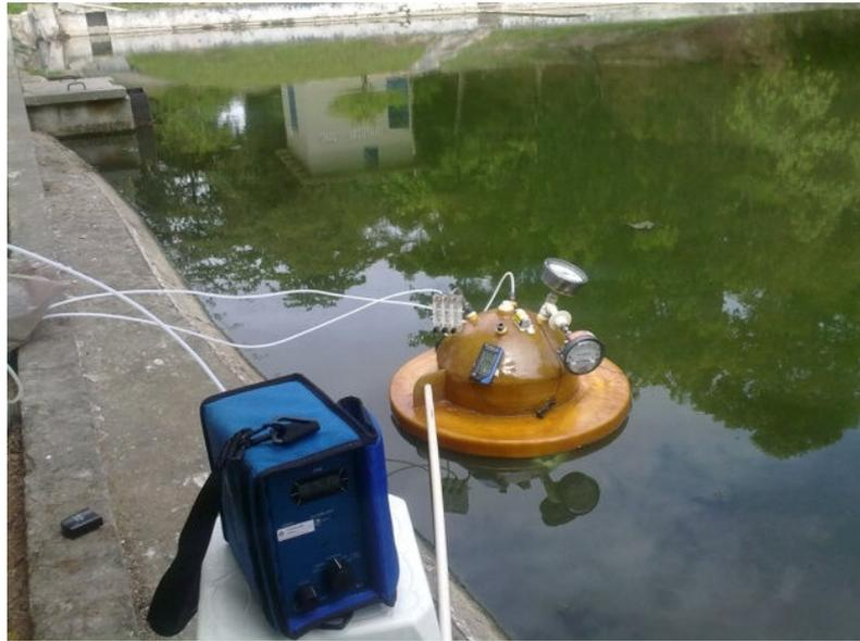
Figura 4-4- Foto da câmara de fluxo dinâmica ao fundo e analisador de H<sub>2</sub>S à frente
