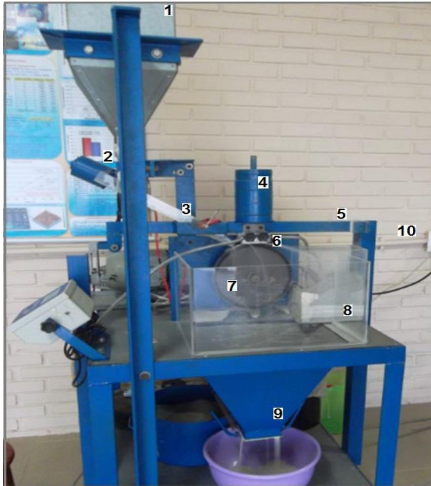
Figura 3-4 – Fotografia do equipamento de ensaio de desgaste abrasivo roda-de-borracha do TRICORRMAT/UFES, em funcionamento.
