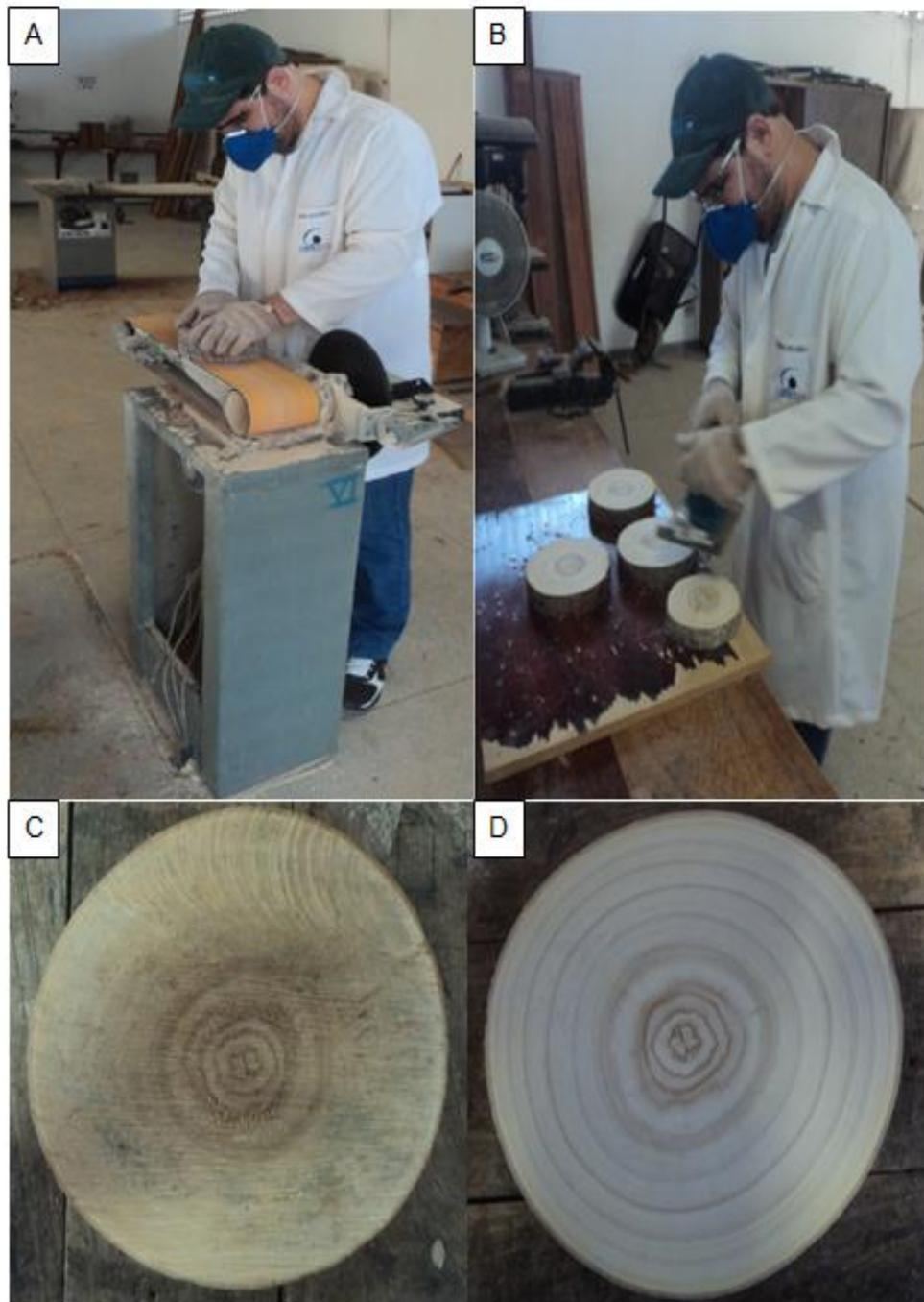
Figura 4. Preparação dos discos para o lixamento. A: Polimento grosso (Lixadeira de cinta); B: Polimento fino (Lixadeira manual orbital) C: Disco sem polimento; D: Disco com a superfície polida.
