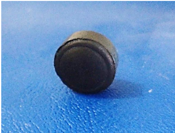
Figura 5. Imã de 850G com sua face lateral marcada
