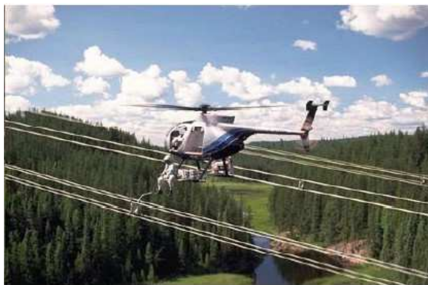
Figura 1.1: Inspeção de linha de transmissão de energia elétrica usando um helicóptero tripulado.
