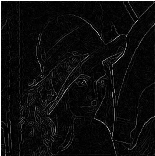
(c) Imagem após a aplicação da supressão de não máximos.
