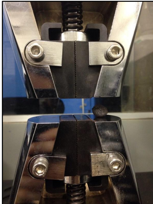
Figura 37: Ensaio de resistência a compressão das pelotas queimadas.
