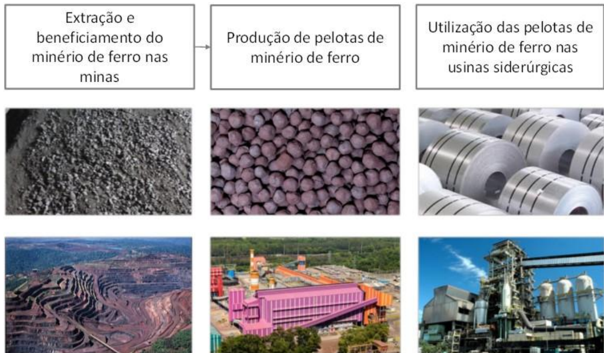
Figura 1: Ilustração dos processos de extração de minério de ferro, processo de pelletização e aplicação das pelotas na siderurgia.
