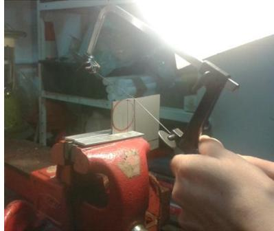
Figura 21 - Procedimento de corte para preparação de corpos de prova.
