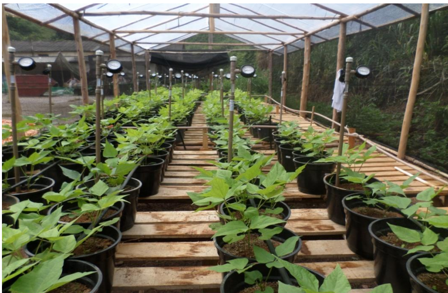
Figura 3. Disposição do sistema de irrigação com os tensiômetros instalados e cultura do feijoeiro em fase de desenvolvimento.
